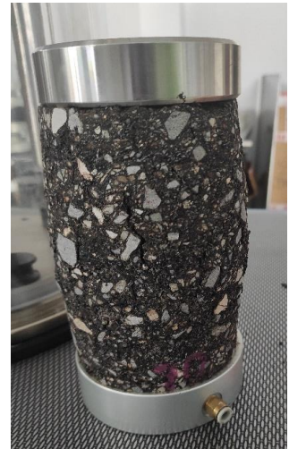
Ocena kohezji - mieszanka BSM poddana badaniu odporności na deformacje trwałe Flow Number
